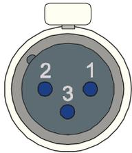
Alle symmetrischen Eingänge sind mit NEUTRIK-XLR-FEMALE-Buchsen mit vergoldeten Kontakten ausgerüstet. Die Belegung ist wie in der professionellen Technik üblich ausgelegt (siehe Bild).
