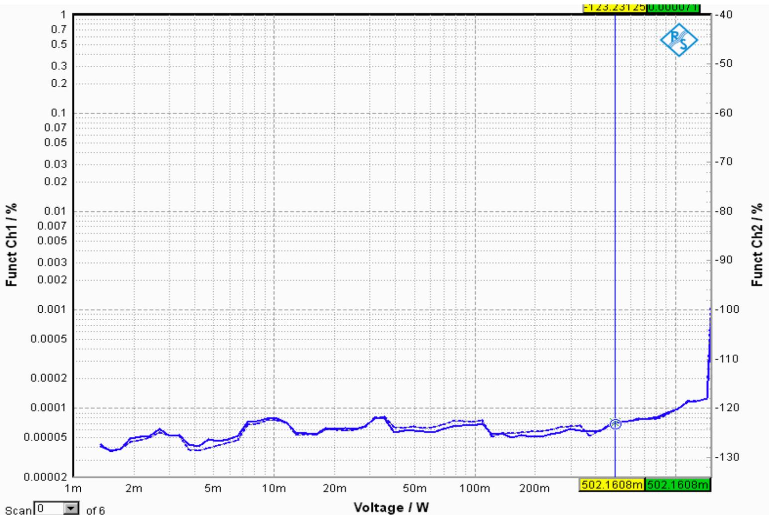
LPA-2S THD bei einem Testsignal von 1 kHz an 2x 62  $\Omega$  über die Leistung von 2x 1,5..1500 mW bei Versorgungsspannungen von  $\pm 19V$ . Sämtliche Harmonischen von k2..k9 sind berücksichtigt. Die Stufen in der Messkurve stammen von der automatischen Verstärkungsumschaltung des Audioanalyzers R&S UPV, der für diese Messung benutzt wurde. Der Cursor zeigt die Messwerte bei ca. 2x 500 mW Ausgangsleistung mit Gesamt-THD von 0,00007 % bzw. -123 dB.
