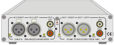
Der **SAM-1Bs** ist ein vielseitiger, professioneller 4-Kanal-Anpassungs- und Symmetrier/ Differenzverstärker (Instrumentenverstärker) in eisenloser Schaltungstechnik für die Verwendung bei höchsten Anforderungen an die Tonqualität. Asymmetrische "Homerecording"- sowie PC-Ein- und Ausgänge und HiFi-Geräte können damit an professionelle symmetrische oder unsymmetrische Studiogeräte-Ein/Ausgänge angepasst werden. Pegelanpassung von -10 dBv auf +6 dBu und umgekehrt sowie
