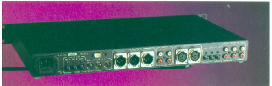
sind auch diese bei den Eingänge koaxial ausgeführt. Die drei Ausgänge "MONITOR", "RECORD A" und "RECORD B" stehen beim DAS jeweils als koaxiale (Consumer-Channel-Status, Cinch), optische (Consumer-Channel-Status, Toslink) und AES3-Variante (Profi-Channel-Status, XLR-Buchsen) zur Verfügung. Bei DAS-C sind keine symmetrischen AES3-Ausgänge vorhanden.
