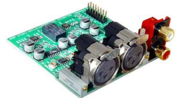
Zweikanal Modul SSIM-04Mb 2-Kanal-Differenz-Verstärker (Asymmetrierverstärker) aus SAM-2B
