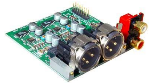
Zweikanal Modul SSOM-04Mb.V2 2-Kanal-Symmetrierverstärker aus SAM-2B.V2
