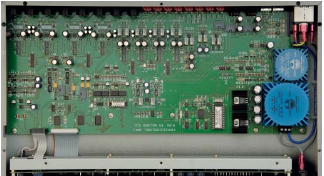
Die beiden Trafos ganz rechts sind klanglich und messtechnisch als potentielle Störquelle nicht wahrnehmbar. In der Bauteilreihe unterhalb der unsymmetrischen Eingänge sind die Spindeltrimm-Potentiometer zum Justieren der Eingangsempfindlichkeiten sichtbar.
