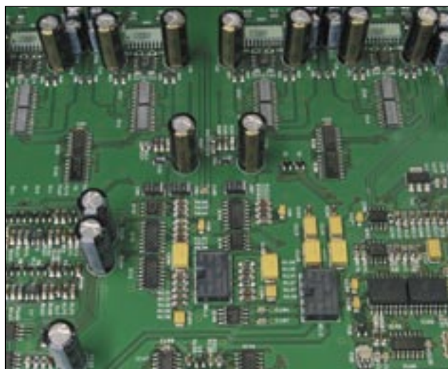
Gemischte Bestückung ist kein Problem. Manche Bauteile (hier Elektrolytkondensatoren) sind auf Grund ihrer Größe nur eingeschränkt in SMD verfügbar
