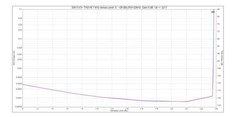
THD+N 1 kHz Signalpegel von 0 dBu bis +26 dBu bei einer Messbandbreite von 20 Hz...22 kHz und Verstärkung der SIA-5.V3+ von 0,0 dB. Der Anstieg der Messkurve bei +22 dBu bis + 25,6 dBu entsteht durch die Eingangsempfindlichkeits-Umschaltung des Analyzers. Die SIA-5.V3+ selbst läuft bis zum Pegel von +25,6 dBu gerade weiter mit ca. -122 dB !! Dies kann der Analyzer aber durch sein erhöhtes Rauschen in diesem Pegelbereich nicht mehr korrekt Anzeigen. Stromversorgung bei dieser Messung +/-22 Volt.
